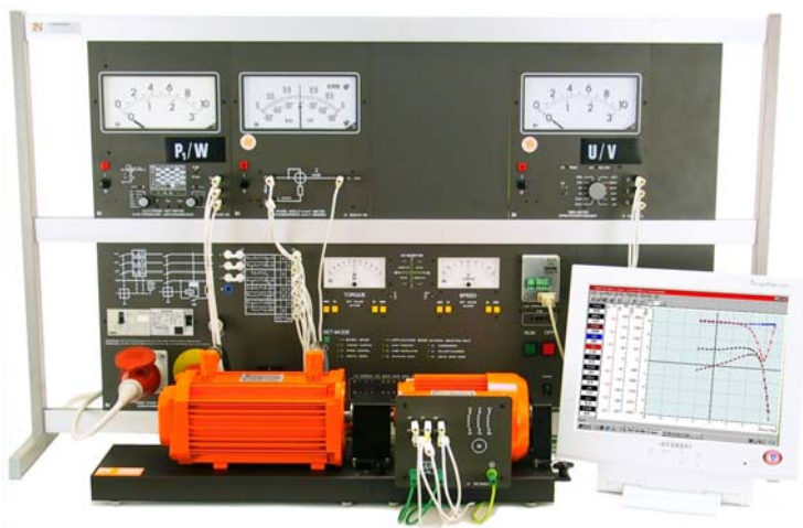
Nuevo Servofreno digital para ensayo de Máquinas eléctricas
