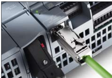
Arriba, imagen de la modularidad proporcionada por Simatic S7-1200, y a la dcha., el Interfaz Profinet.
